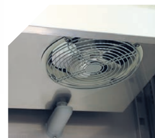
Evaporador de tiro forzado.
