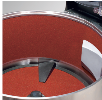
Sistema de abrasión en plato y lateral.
