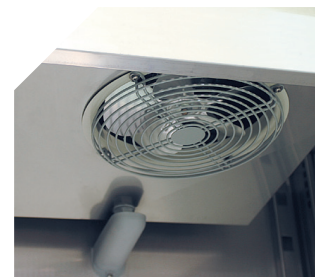
Evaporador de tiro forzado.
