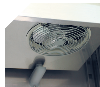
Evaporador de tiro forzado.
