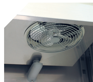
Evaporador de tiro forzado.
